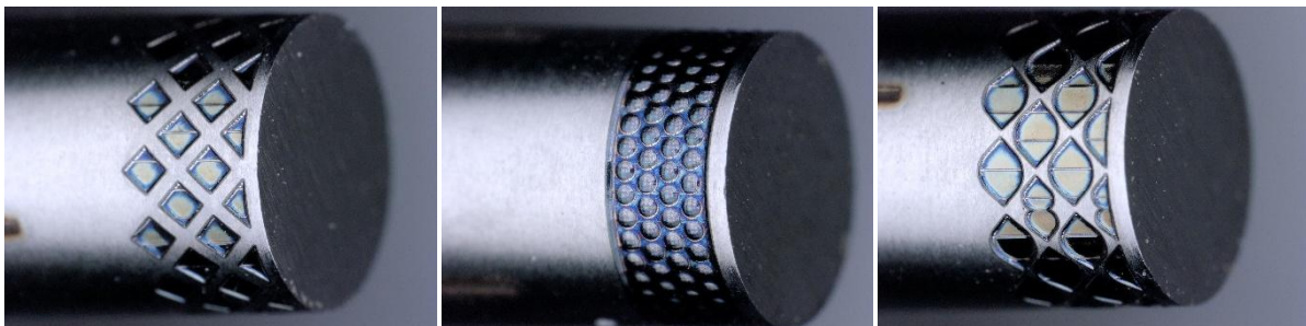
Abbildung 1: strukturierte Rundstempel Layouts für Versuchsteil B – Einsatz im Bandwerkstoff DC04 und 1.4310 Verschiedene Strukturdesigns zur Optimierung der Schmiermittelhaltung (Bericht Seite 22).
